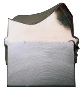
Querschnitt des elektronenstrahlschweißten Zahnkranzes und Grundkörpers, zur Veranschaulichung der Verbindung des Bronzekranzes mit dem gusseisernen Grundkörper. Diese leistungsstarke Verbindung ermöglicht Kraftübertragungen unter Stoßbelastungen.
