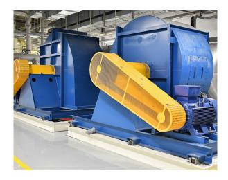
Accouplement installé entre le moteur électrique à fréquence variable et la courroie du ventilateur
