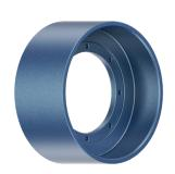
Des tambours de freins peuvent être associés toute la gamme d'accouplement PM et peuvent être boulonnés sur la bride d'entraînement ou la moitié flexible de l'accouplement. Le creux - ØA - est situé sur le diamètre extérieur de l'accouplement.
