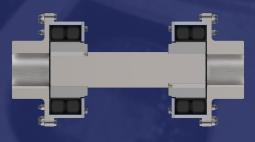
Accouplement d'arbre à cardan. Utilisé pour augmenter la distance entre les extrémités d'arbres et pour donner une capacité de désalignement supérieure.
