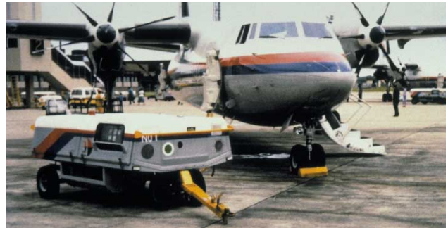
Acoplamiento RB 0.37 montado sobre volante en un ADE - HML unidad de alimentación en tierra
